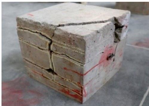
图2 物模样品裂缝扩展
