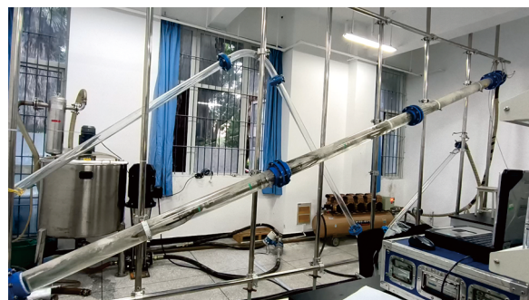
图1 倾斜井条件下气水两相流模拟实验系统
