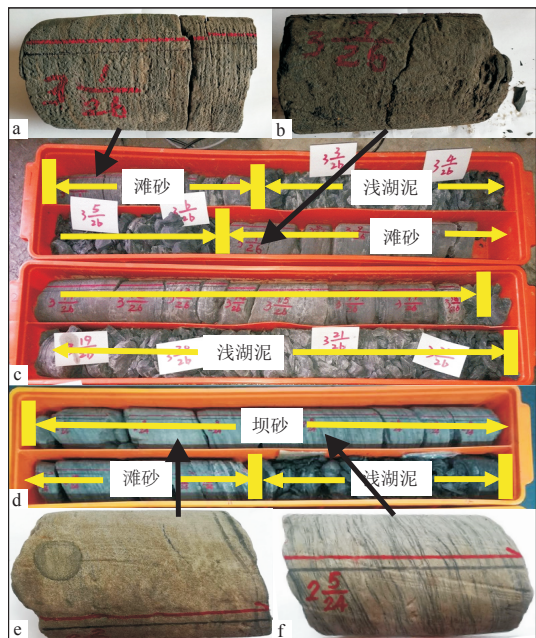
a.J2井,1 641.02 m,褐灰色油斑粉砂岩,水平层理,条带状含油;b.J2井,1 642.43 m,褐灰色油斑粉砂岩,波状层理;c.J2井,1 641.02~1 643.72 m,第三次取心全筒照片,顶底泥岩突变接触;d.CA3井,2 195.59~2 197.59 m,第二次取心全筒照片,整体呈下细上粗反韵律特征,底部泥岩突变接触;e.CA3井,2 195.79 m,灰色粉砂岩,块状层理,含泥岩撕裂片,岩心表面见黄铁矿斑块;f.CA3井,2 196.15 m,灰色粉砂岩夹灰黑色泥质条带,发育波状交错层理、透镜状层理、生物扰动
