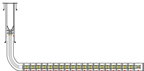
图3 悬挂器+滑套+封隔器管柱示意图
