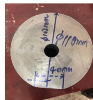
图2 铅模出井照片 Fig. 2 Lead mold
