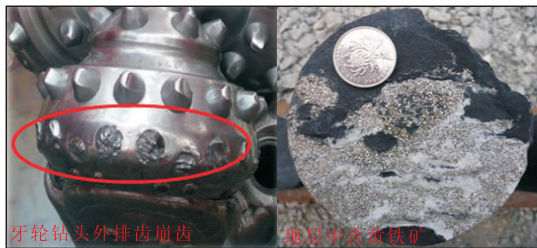
图5 牙轮断齿和地层中含黄铁矿
